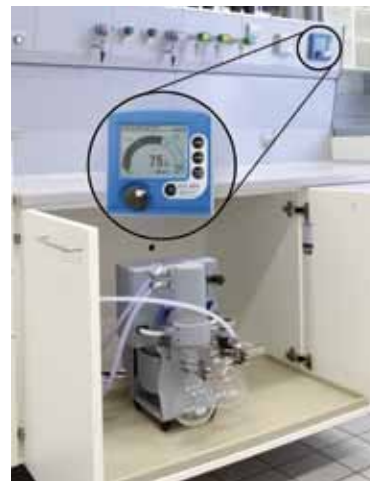
Estación de bombeo de red versión química debajo de la campana de gases, con recuperación de disolventes. Operación a través de la consola de medios
