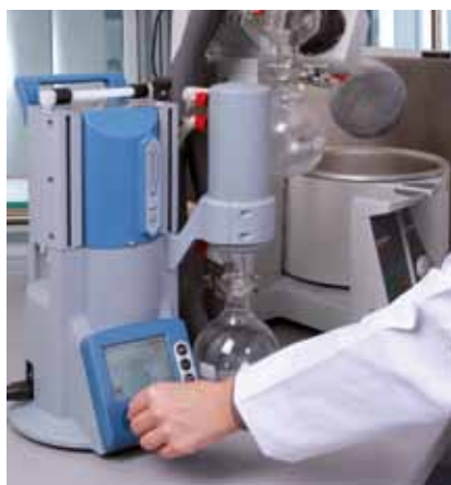
Suministro para un solo usuario: vacío grueso con una estación de bombeo versión química en un evaporador rotativo
