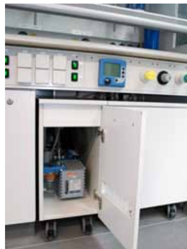
Suministro para un solo usuario: vacío fino, línea Schlenk
