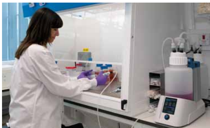
Suministro para un solo usuario: vacío grueso en la aspiración de líquidos
