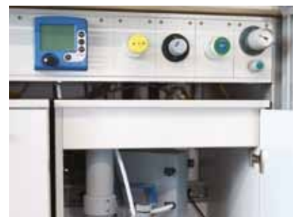
Instalación debajo de la mesa de trabajo con posibilidad de control al alcance del operador
